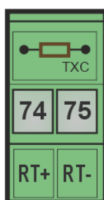
Рисунок Б.2.4 – Підключення датчика термокомпенсації
