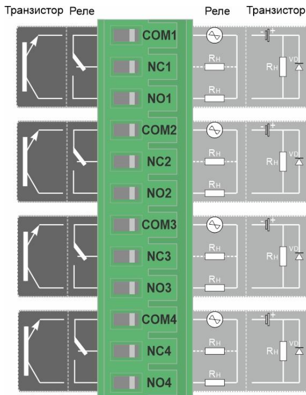
Рисунок Б.2 – Підключення дискретних навантажень до індикатора ITM-120-K6
