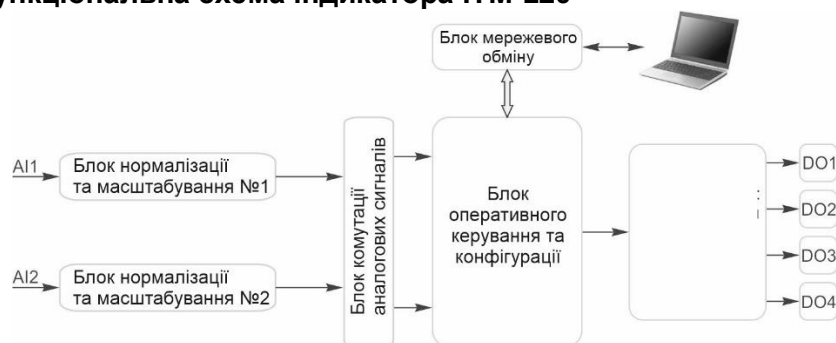
Рисунок 3.3 – Функціональна схема індикатора ІТМ-120
