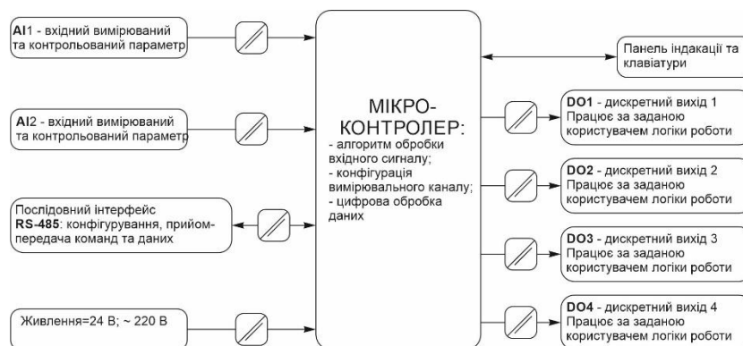
Рисунок 3.2 – Структурна схема індикатора ІТМ-120
