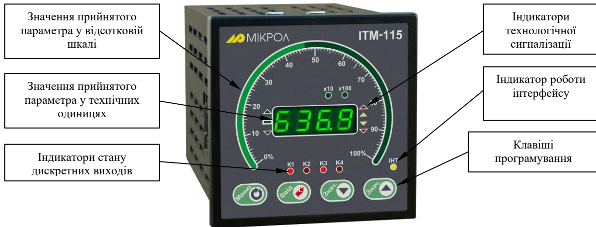
Рисунок 3.1 - Зовнішній вигляд індикатора ITM-115C
