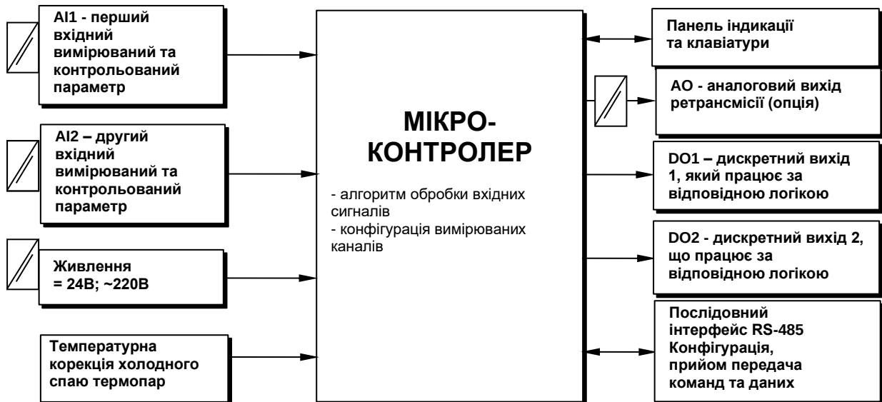
Рисунок 3.2 - Структурна схема індикатора ITM-112
