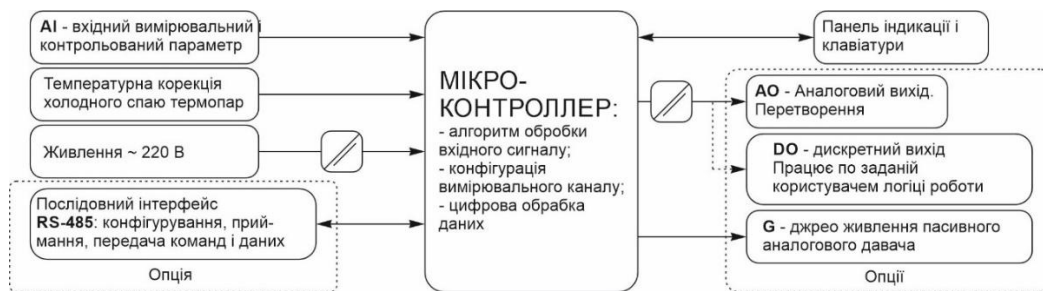
Рисунок 3.2 - Структурна схема індикатора ITM-101(B)
