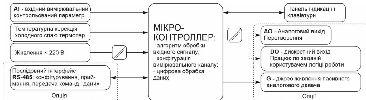
Рисунок 3.2 – Структурна схема індикатора ITM-100
