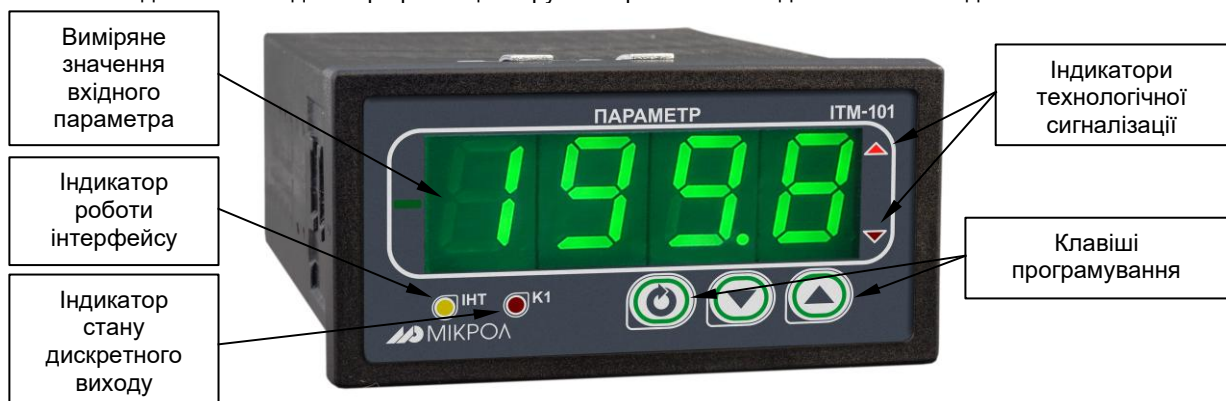
Рисунок 3.1 - Зовнішній вигляд індикатора ITM-100
