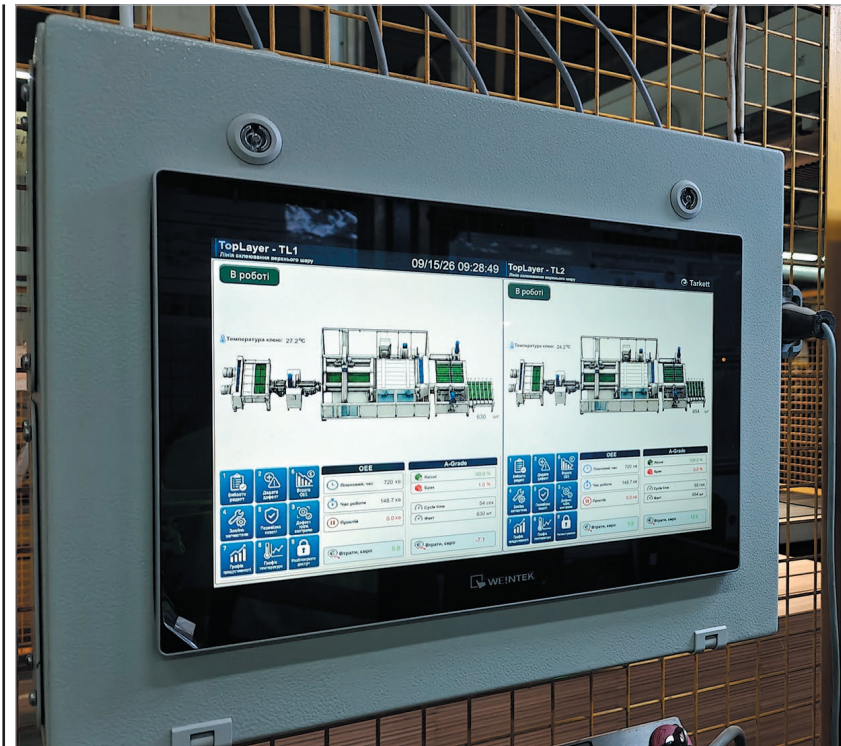
Рис. 12. Візуалізація техпроцесу на WEINTEK cMT3162X 15
