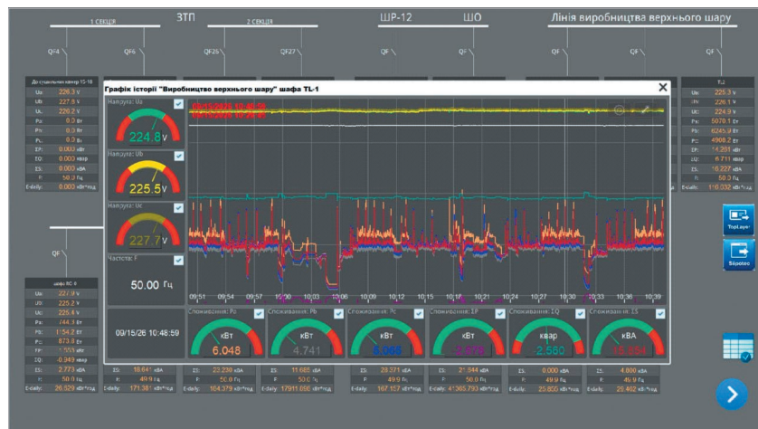
Рис. 5. Візуалізація споживання електроенергії у Weintek cMT Viewer
