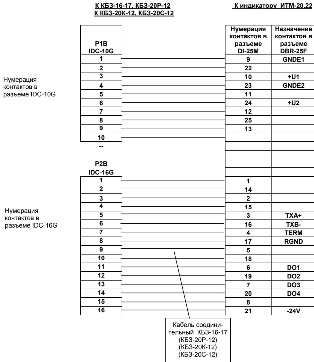
*Рисунок Б.5 - Схема распайки кабеля клеммно-блочных соединителей КБ3-16-17-0,75, КБ3-20Р-12-0,75,
