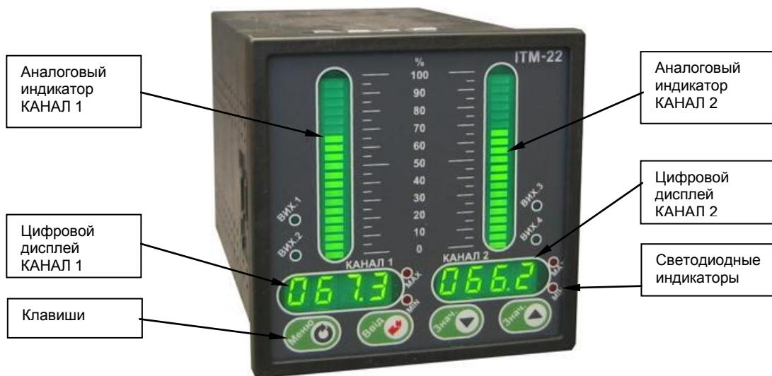
Рисунок 3.1 - Внешний вид передней панели индикатора ИТМ-22
