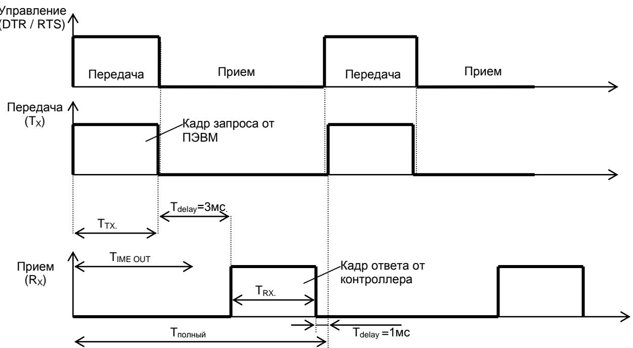
Рисунок В.1 - Временные диаграммы управления передачей и приемом блока интерфейсов БПИ-485 (БЛИ-52)
