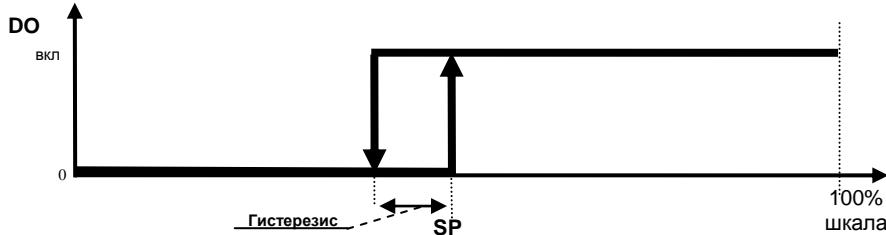
Рисунок 3.6 – Пример работы выходного устройства по логике 2-х позиционного управления
