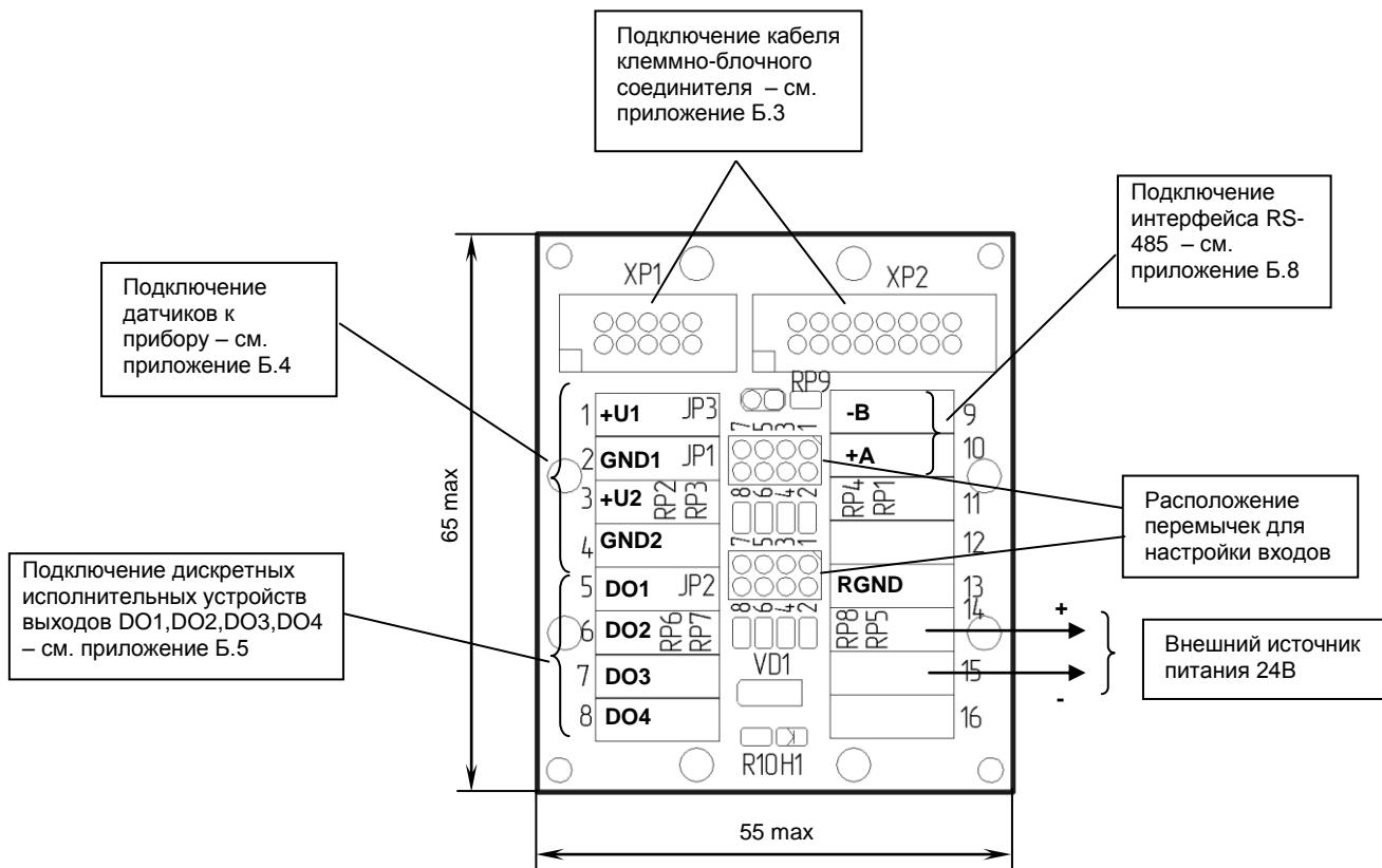
*Рисунок Б.3 - Схема расположения сигналов и габаритные размеры клеммно-блочного соединителя КБ3-16-17*
