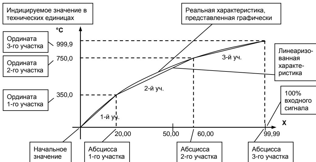
Рисунок 5.1 – Линеаризация сигнала, подаваемого на вход AI1, представленная графически (кривой)
