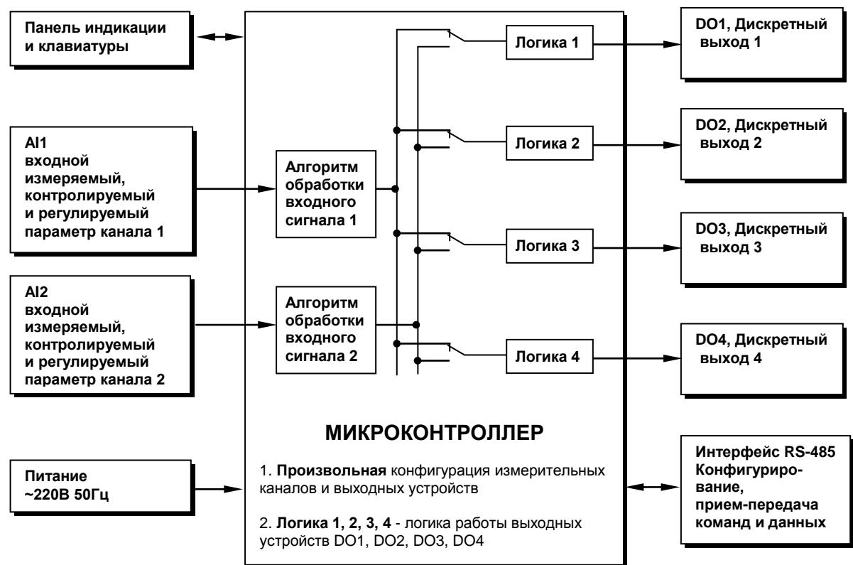
Рисунок 3.3 - Структурная схема индикатора ИТМ-22 (ИТМ-20)
