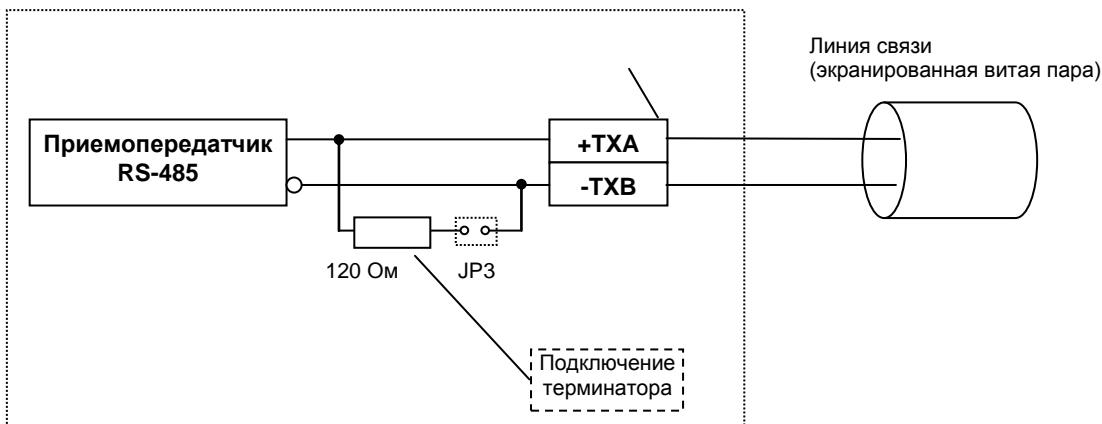
Рисунок Б.13 - Рекомендуемая схема подключения интерфейса RS-485 с помощью КБ3-16-17, КБ3-20Р-12, КБ3-20К-12 или КБ3-20С-12
