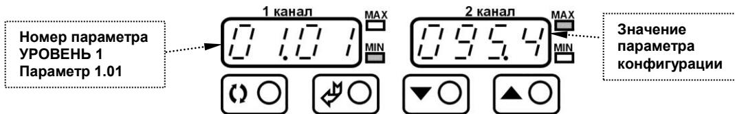
Рисунок 4.3 - Индикация значения параметров конфигурации и их номеров
