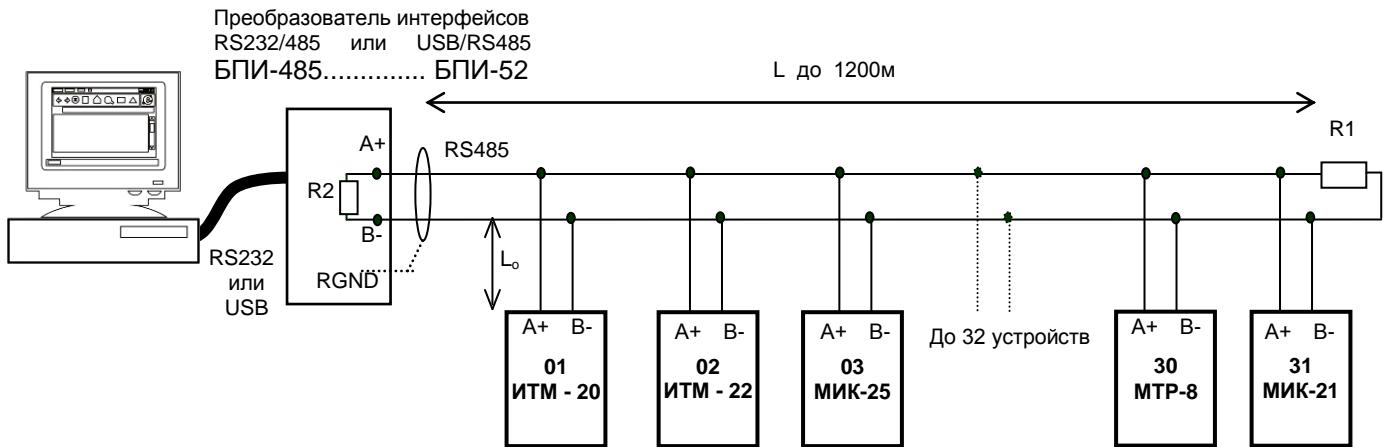
Рисунок Б.12 - Организация интерфейсной связи между компьютером и контролерами
