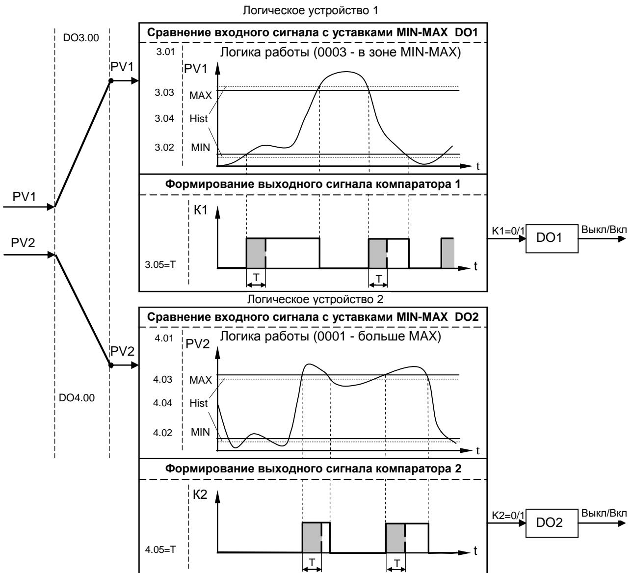
Рисунок 3.7 – Функциональная схема принципа работы компаратора
