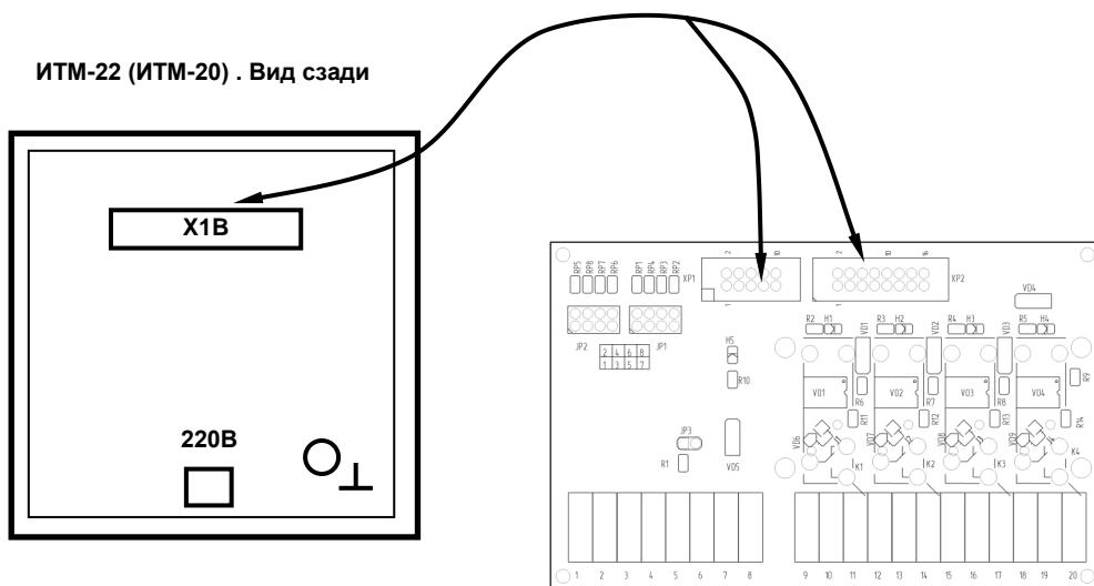
Рисунок Б.2 - Подключение клеммно-блочного соединителя к индикатору ИТМ-22(ИТМ-20):
