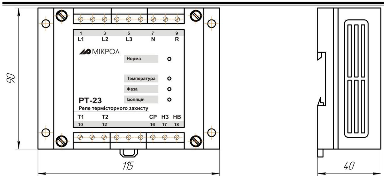
Рисунок 1.1 - Внешний вид и габаритные размеры РТ-23
