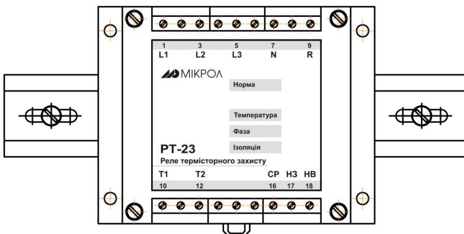
Рисунок 4.1 – Схема крепления прибора на щит
