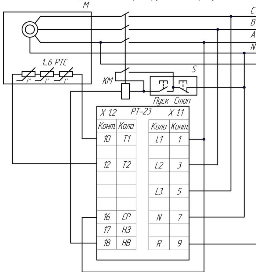
Рисунок 4.2 – Схема электрических подключений
