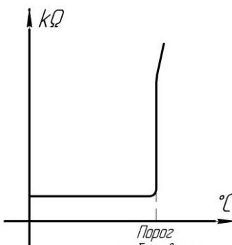
Рисунок 2.1 – Принцип работы позисторов
