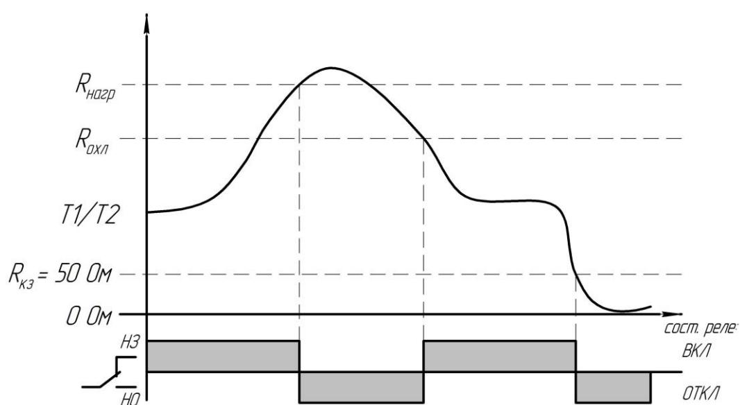
Рисунок 2.2 – Диаграмма работы канала контроля температуры
