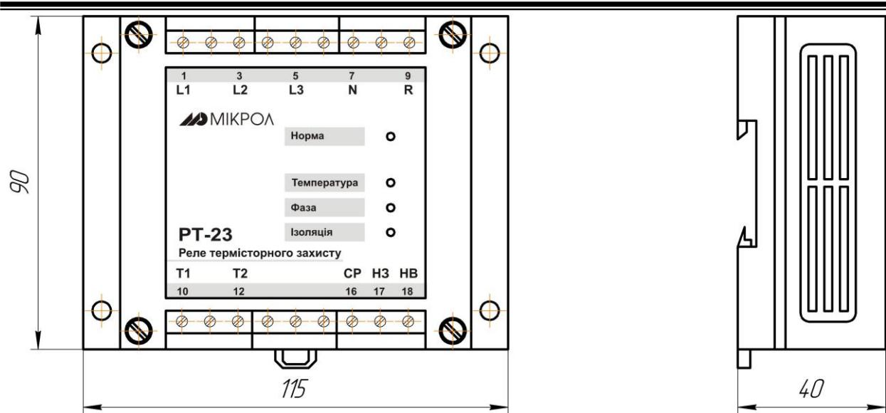
Рисунок 1.1 - Внешний вид и габаритные размеры РТ-23
