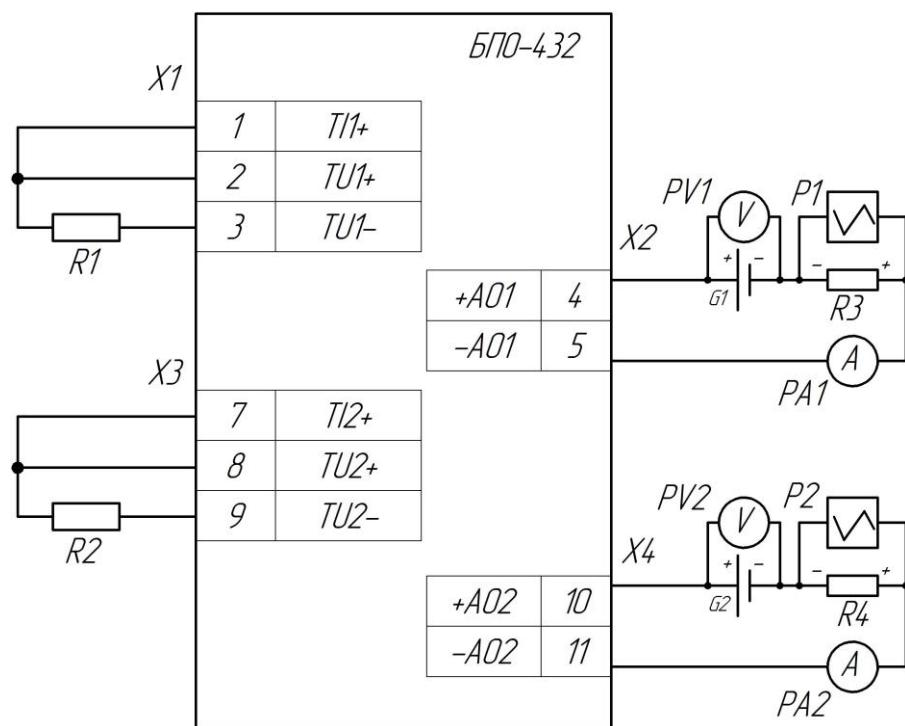
Рисунок А.2 – схема наладки блока БПО-432
