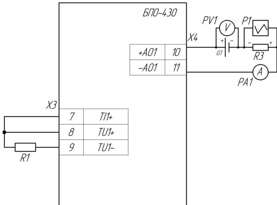
Рисунок А.1 – Схема наладки блока БПО-430
