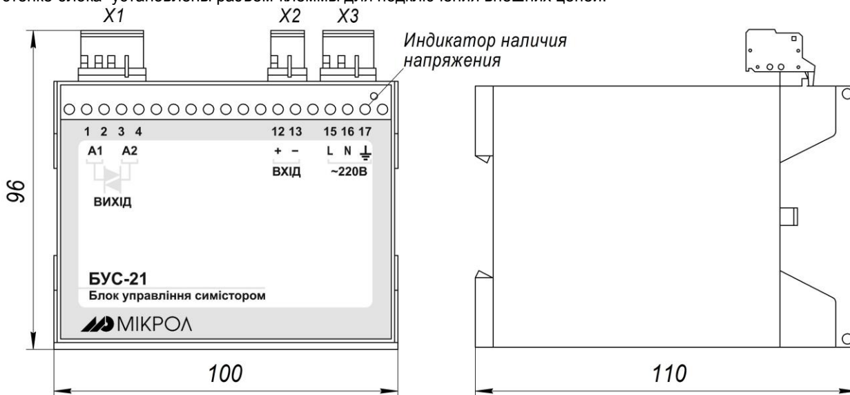
Рисунок 1.4 – Внешний вид и габаритные размеры блока БУС-21
