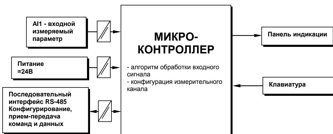
Рисунок 5.3 - Структурная схема индикаторов ИТМ-1-01-31 и ИТМ-1-01-41
