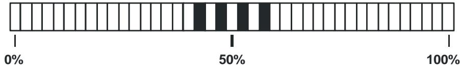
Для модификации этого параметра необходимо кратковременно нажать клавишу [○]. На индикаторе выводится значение измеряемого параметра (для примера, на рисунку входной сигнал был взят 38% от шкалы измерения) с типом шкалы *сегмент* :
