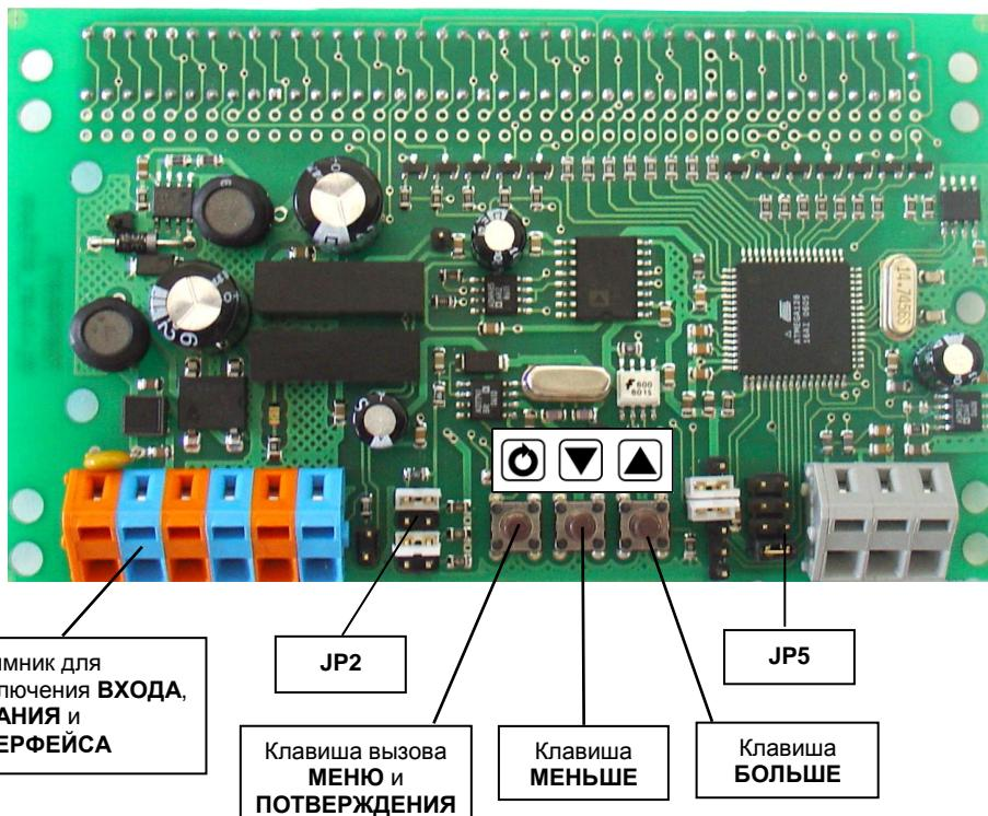
Рисунок 5.2 – Индикатор ИТМ-1-01-41. Вид сзади.
