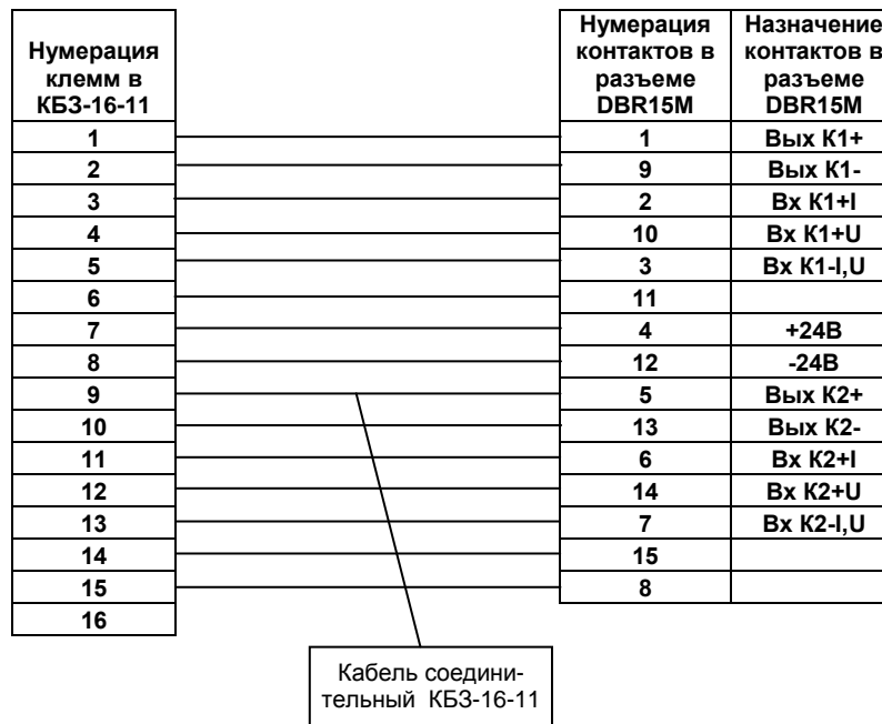
Рисунок 2.4 - Схема распайки кабеля клеммно-блочного соединителя КБЗ-16-11 и внешние сигналы БПО-32
