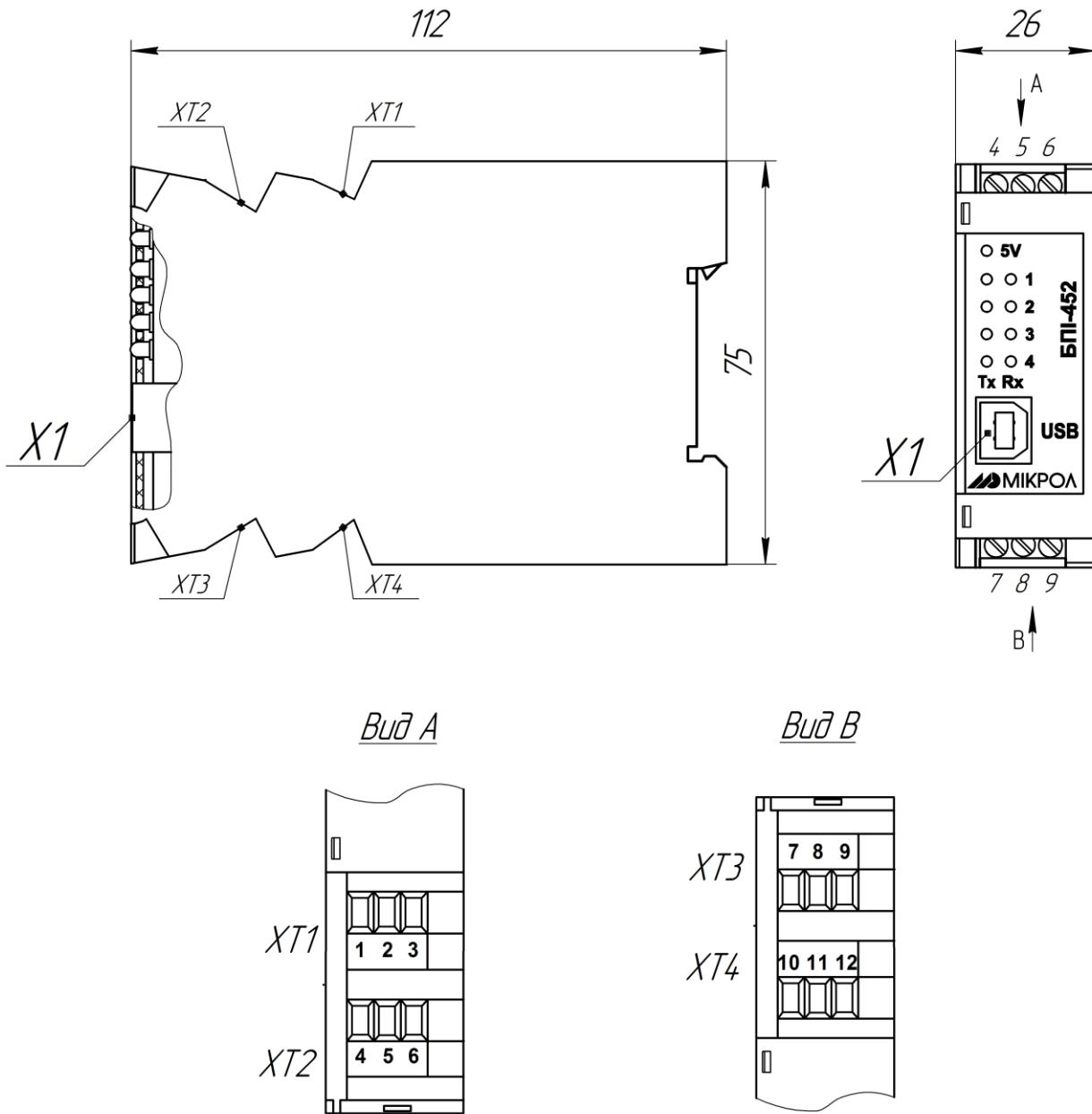
А.1 Габаритные и присоединительные размеры блок БПИ-452. Внешние электрические соединения.
