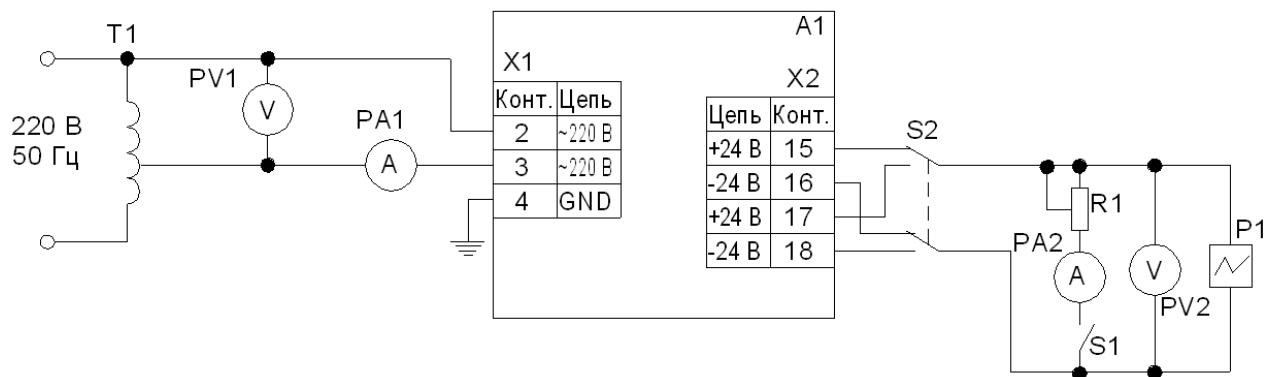
При проверке второго канала блока питания цепи проверки выходного напряжения нужно подключать к контактам 17(+) и 18(-).
