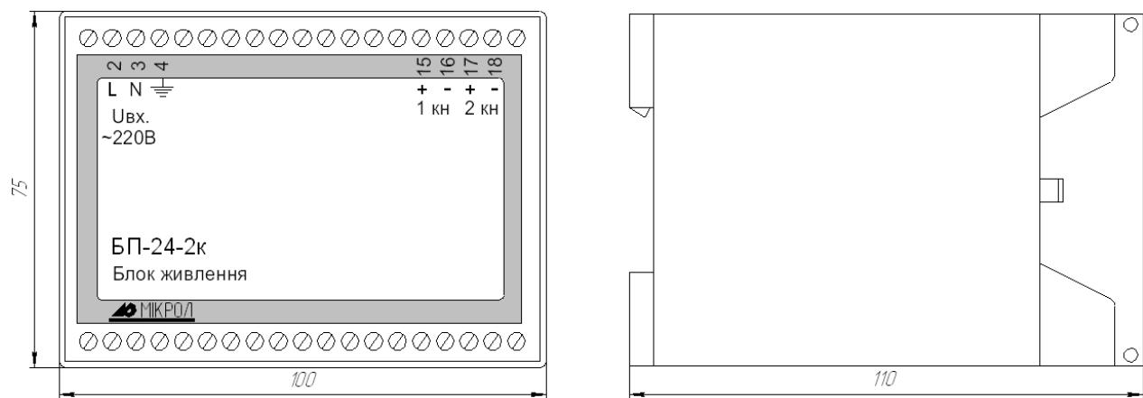
Рисунок 1.1 - Внешний вид и габаритные размеры блока питания
