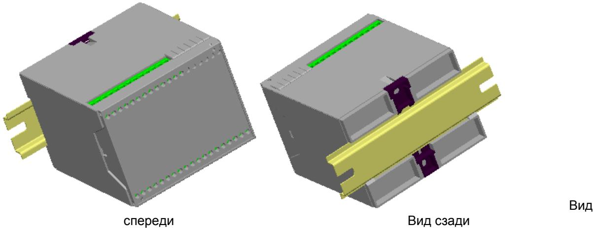
Рисунок 3.1 - Схема крепления блока питания на щите
