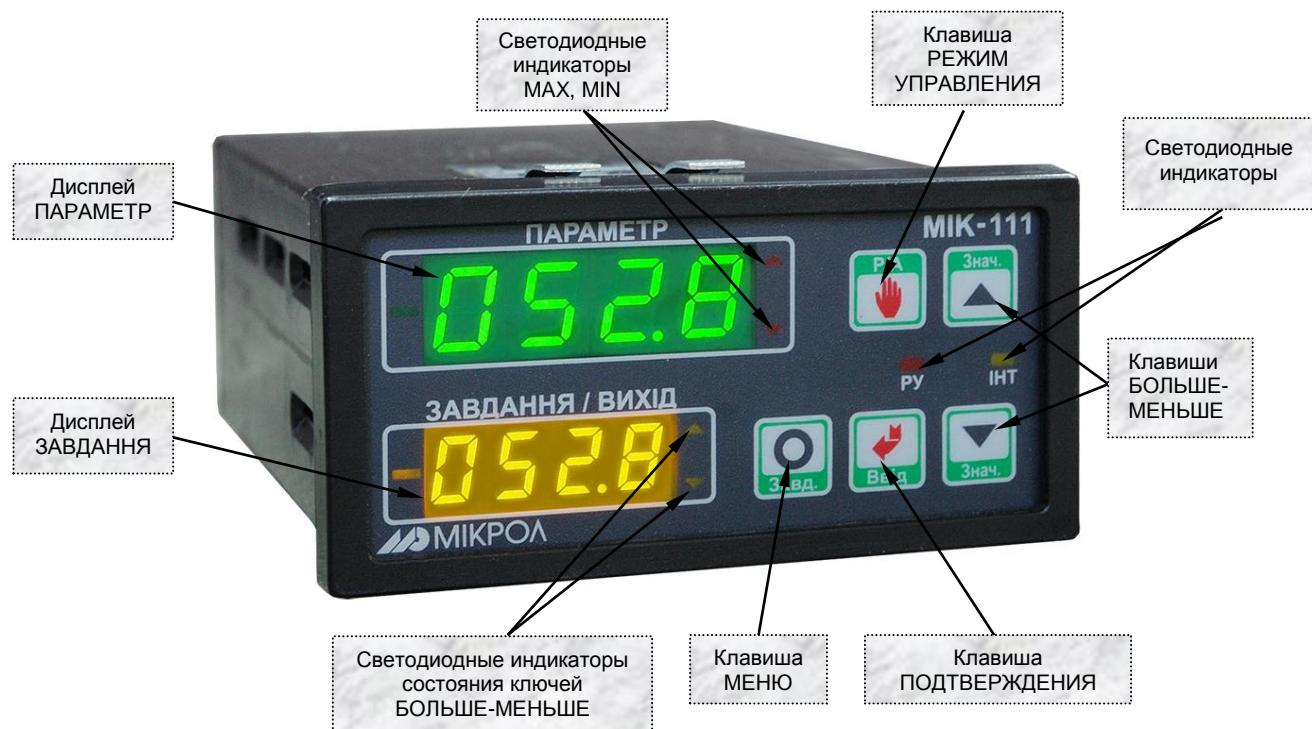
Рисунок 3.1 - Внешний вид передней панели регулятора МИК-111
