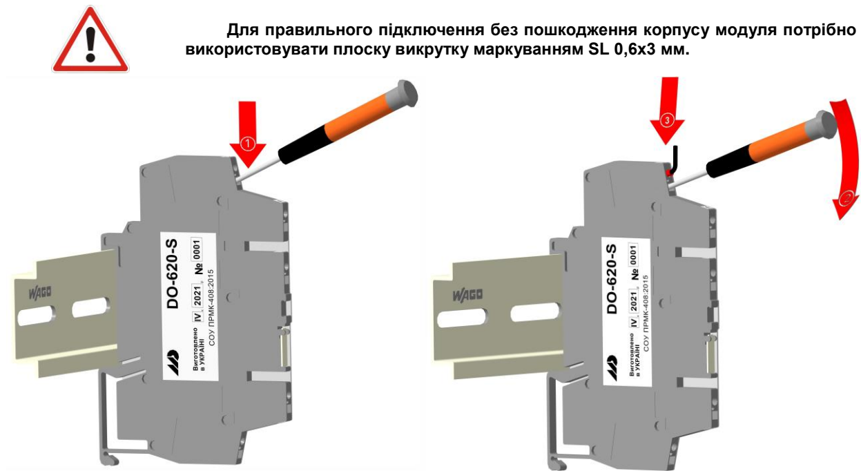
Рисунок 3.3 - Підключення проводів за допомогою плоскої викрутки
