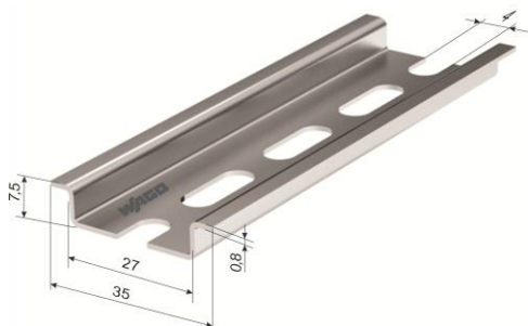
Рисунок 3.2 – Внешний вид и размеры DIN-рейки Wago
