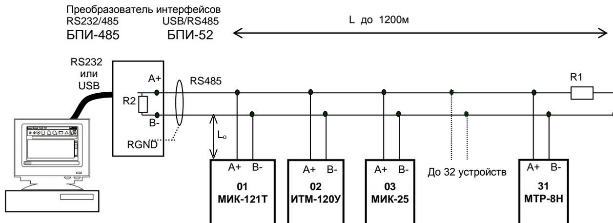
Рисунок Б.5 - Организация интерфейсной связи между компьютером и приборами
