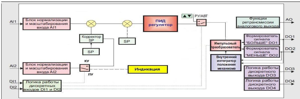
Рисунок 3.13 – Структурная схема импульсного регулятора с внешней коррекцией
