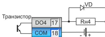
Рисунок Б.3 – Схема подключения индуктивной нагрузки для транзисторного выхода
