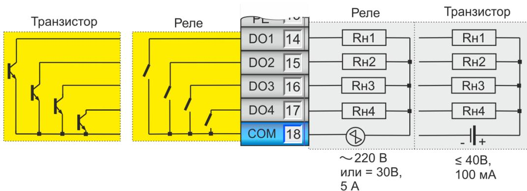
Рисунок Б.2 - Подключение дискретных нагрузок к регулятору МИК-121Т
