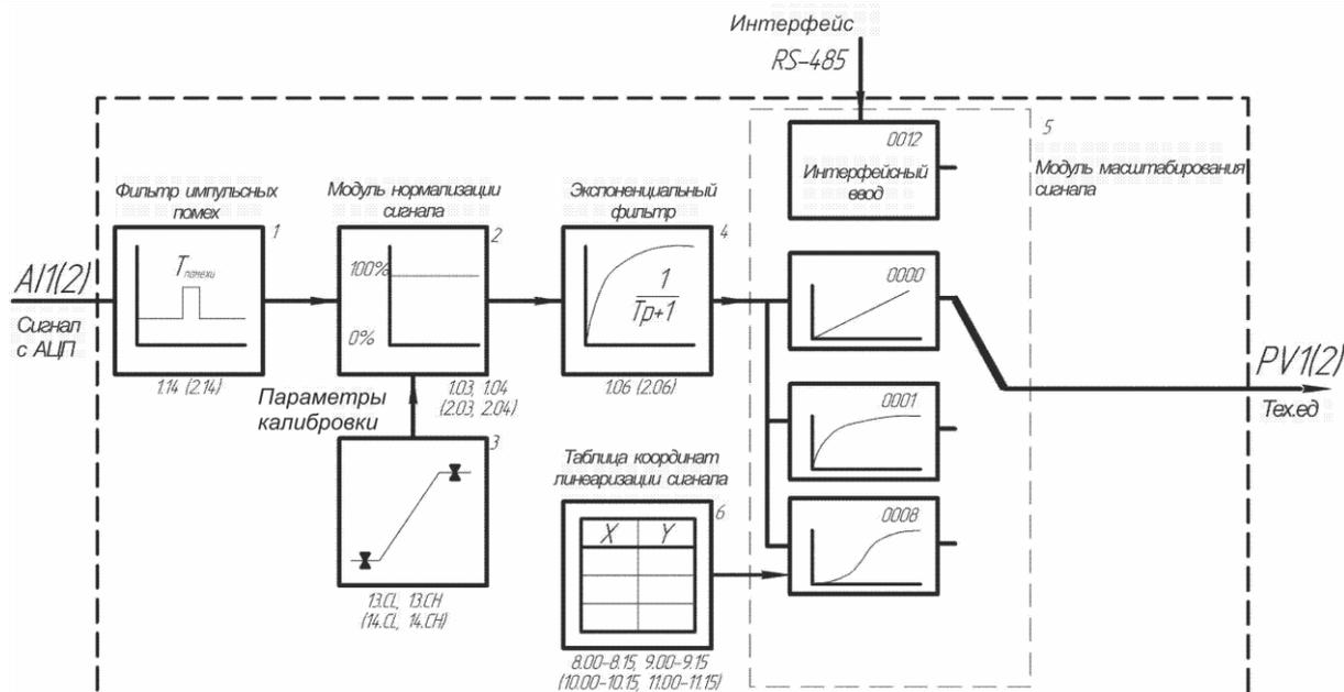
Рисунок 3.15 – Функциональная схема блока преобразования входного сигнала
