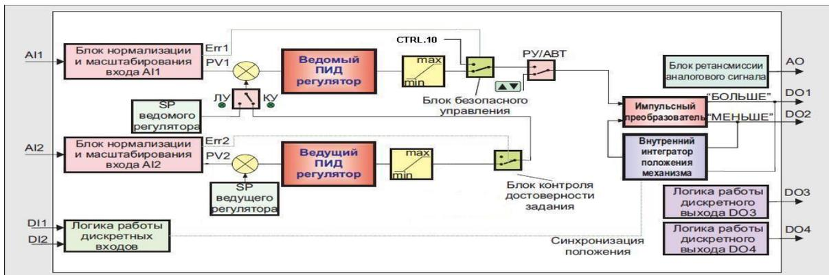
Рисунок 3.12 – Структурная схема каскадного импульсного регулятора
