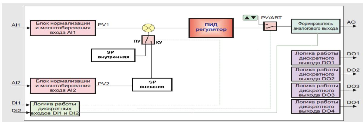
Рисунок 3.9 – Структурная схема регулятора с внешним заданием
