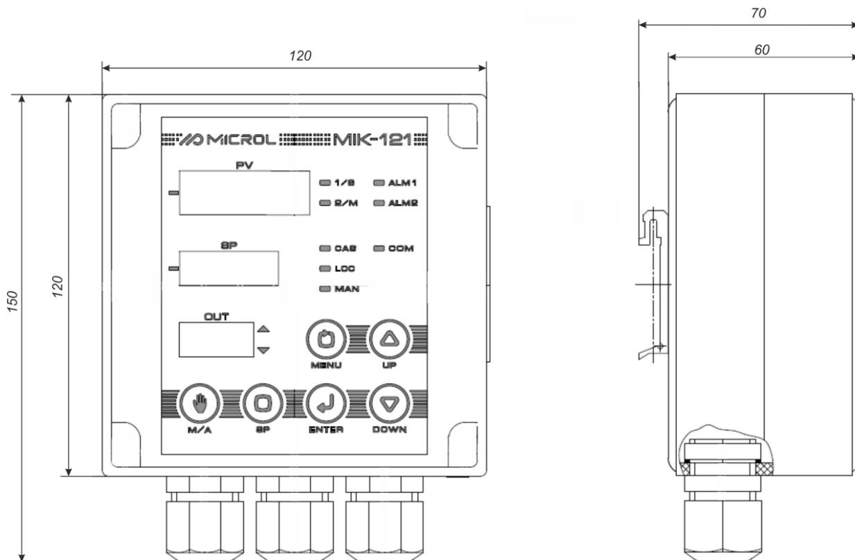
Рисунок А.2 – Габаритные размеры регулятора МИК-121Т
