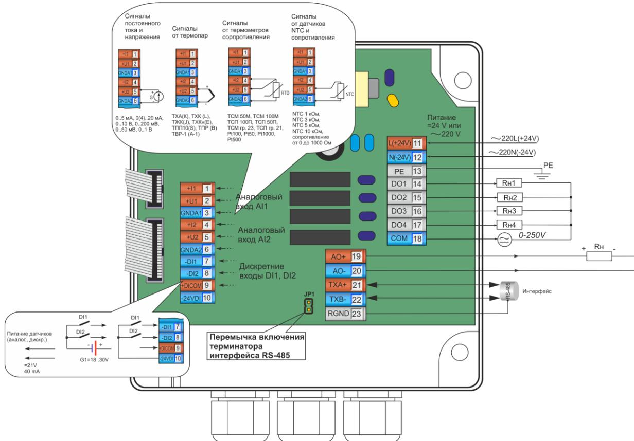
Рисунок Б.1 – Схема внешних соединений регулятора МИК-121Т
