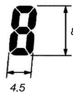
Рисунок А.1 – Внешний вид, размеры цифровых и линейных индикаторов
