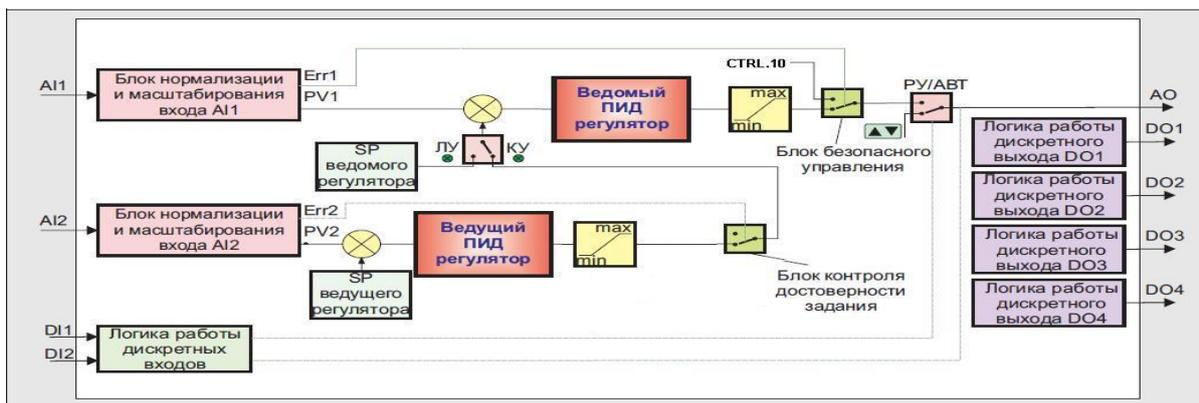
Рисунок 3.7 – Структурная схема каскадного аналогового регулятора
