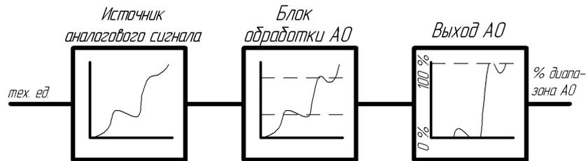
Рисунок 3.19 – Работа блока аналогового вывода в режиме ретрансмиссии
