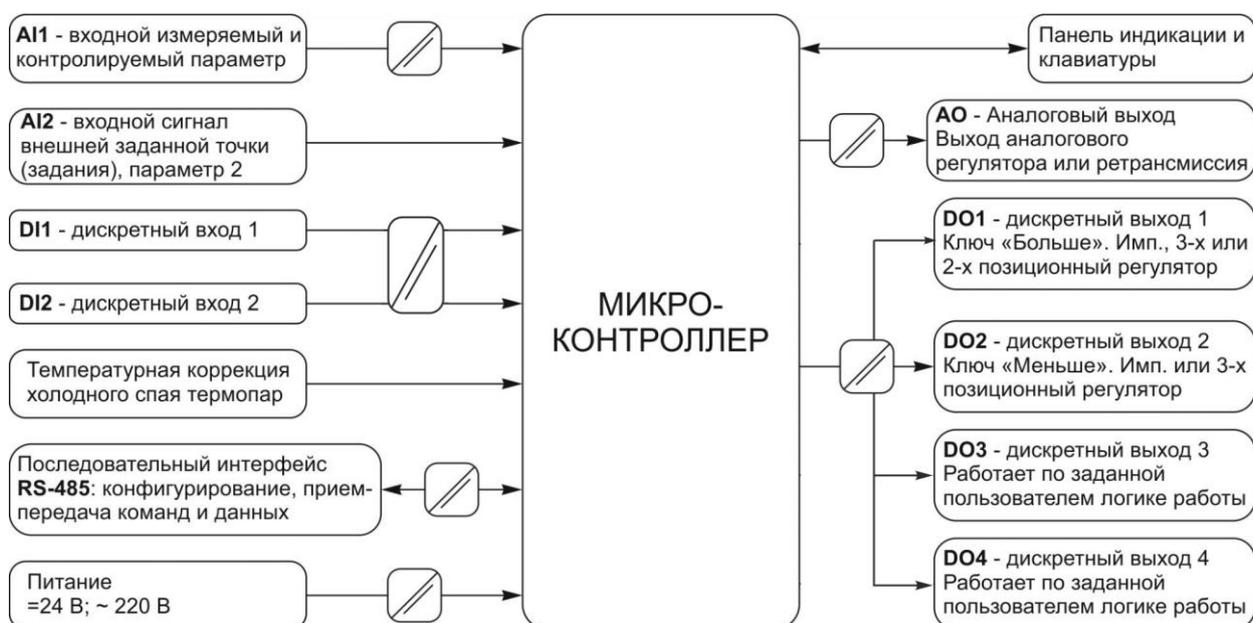
Рисунок 3.2 – Структурная схема регулятора МИК-121Т
