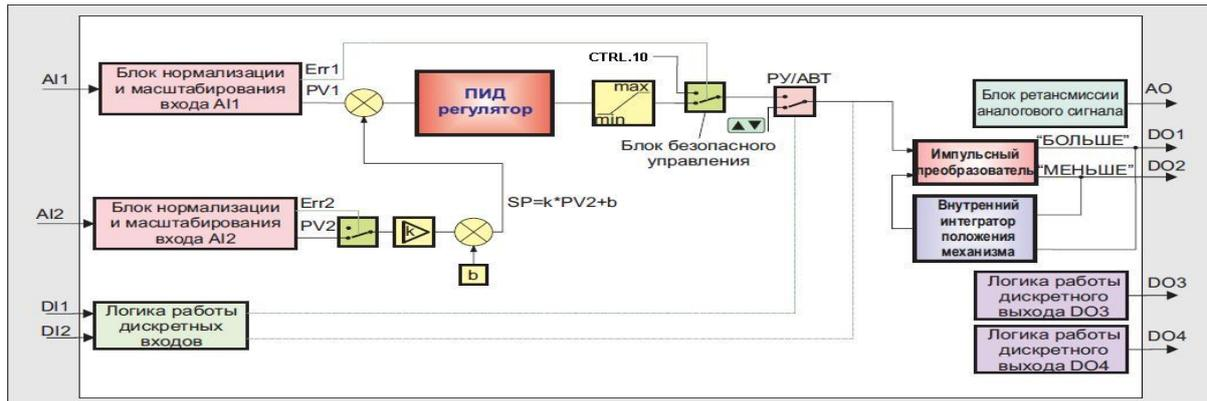
Рисунок 3.11 – Структурная схема импульсного регулятора соотношения
