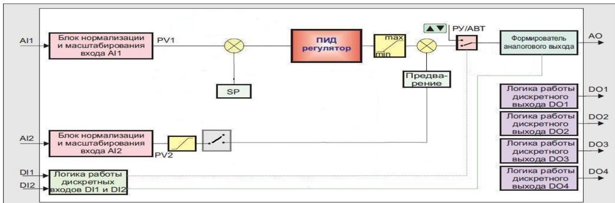
Рисунок 3.5 – Структурная схема стандартного ПИД аналогового регулятора
