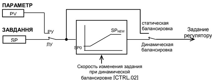
Рисунок 4.2 – Функциональная схема балансировок регулятора МИК-121Т
