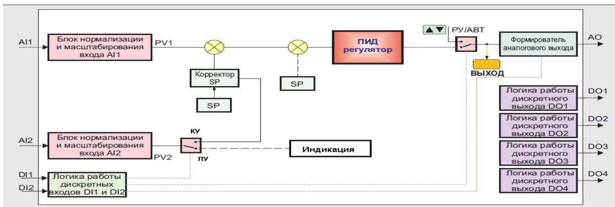
Рисунок 3.8 – Структурная схема регулятора с внешней коррекцией задания
