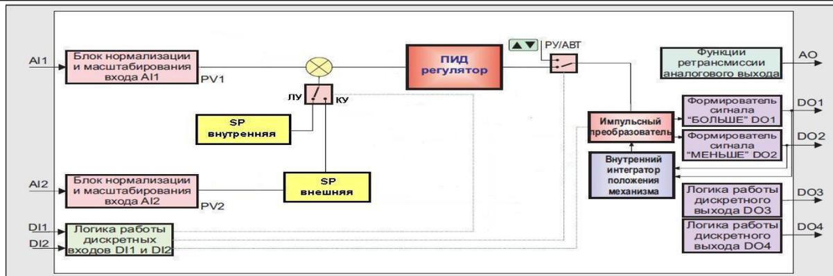
Рисунок 3.14 – Структурная схема импульсного регулятора с внешним заданием
