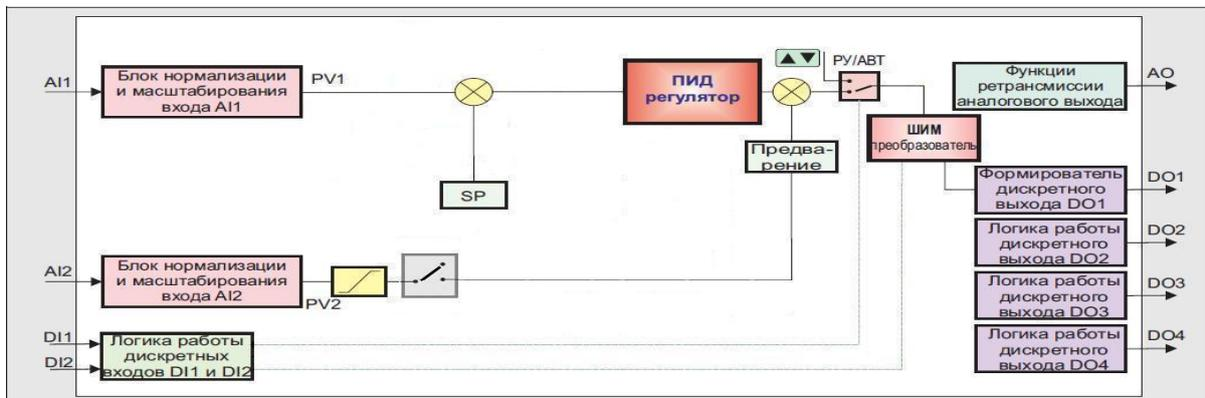
Рисунок 3.4 – Структурная схема ПИД-ШИМ регулятора
