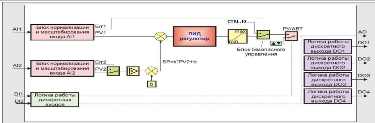
Рисунок 3.6 – Структурная схема аналогового регулятора соотношения
