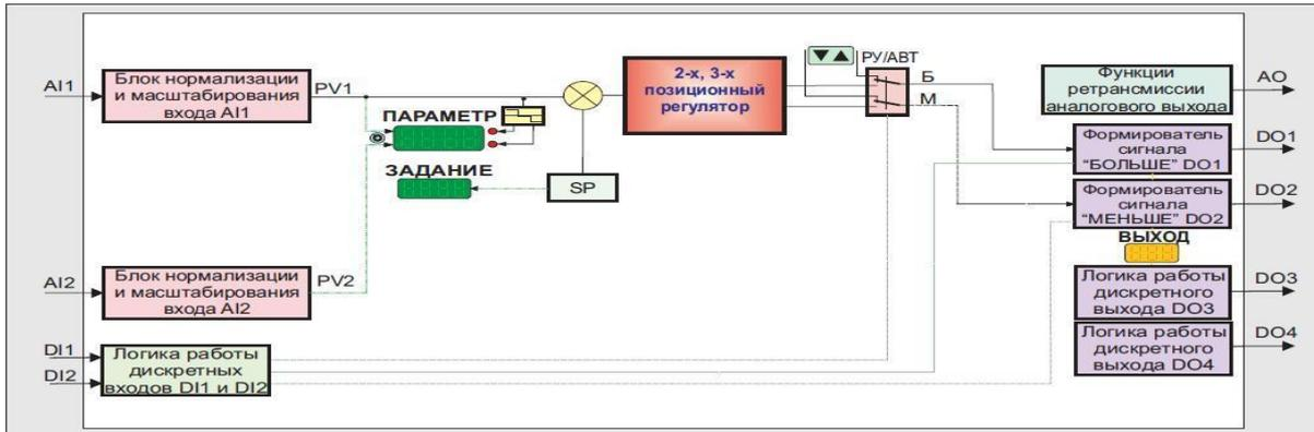
Рисунок 3.3 – Структурная схема 2-х, 3-х позиционных регуляторов
