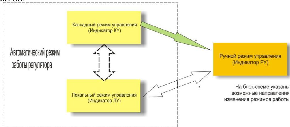
Рисунок 4.1 – Выбор режима управления регулятором.
