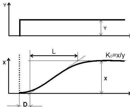
Рисунок 4.4 - Переходная функция объекта регулирования с самовыравниванием
