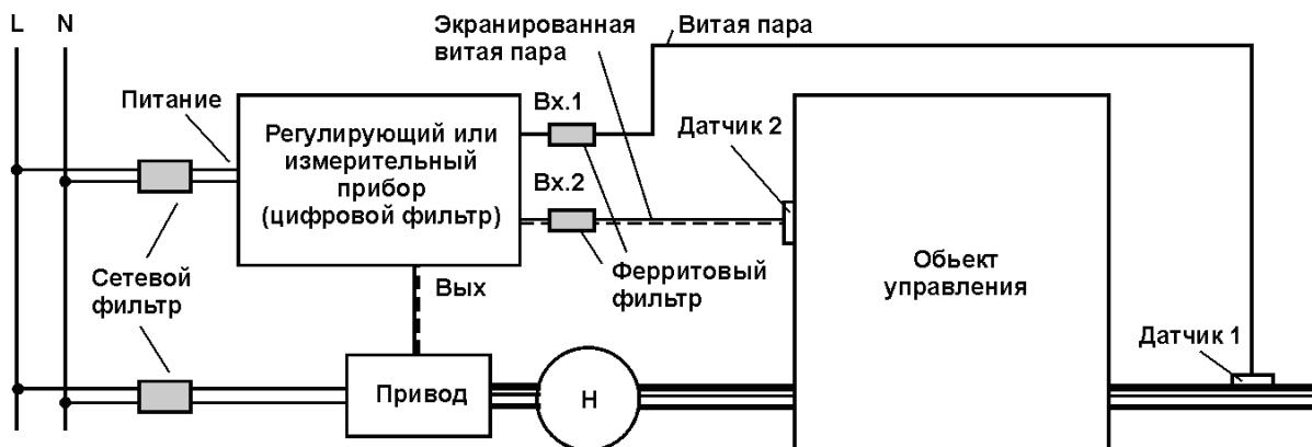
**Рисунок 2 – Блок-схема системы управления, предназначенной для работы в зоне с электромагнитными помехами и шумами. Источником помех в данной системе является двигатель электропривода. На блок-схеме представлены входные сигнальные фильтры, сетевые фильтры. Сетевой фильтр привода должен предотвращать выброс помех в сеть питания. Регулирующий (измерительный) прибор работает с включенным фильтром.**
