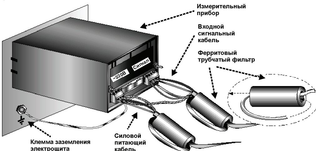
Рисунок 1 – Установка ферритовых фильтров
