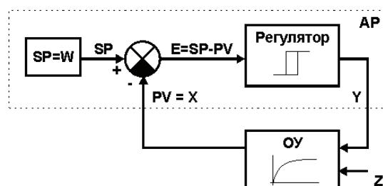
Рисунок 3.1 - Структурная схема двухпозиционной системы регулирования
