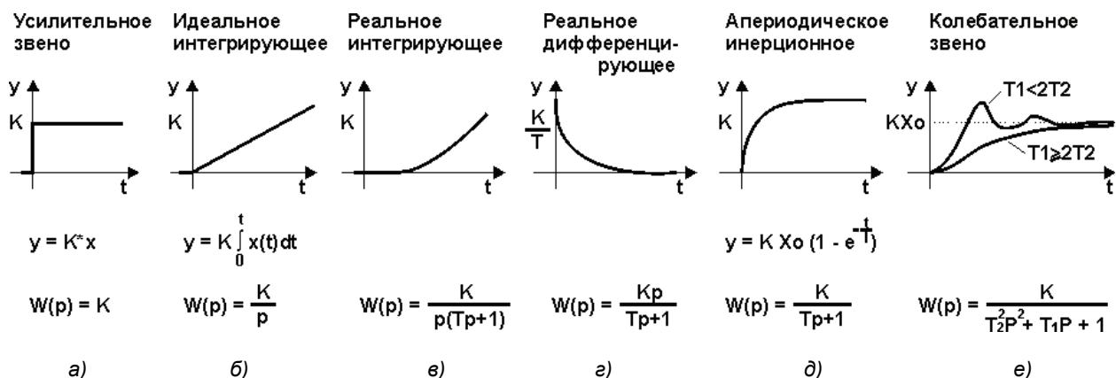
Рисунок 2.4 - Переходные характеристики и передаточные функции типовых звеньев
