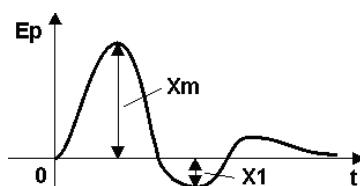
Рисунок 2.12 - График переходного процесса при отработке возмущения
