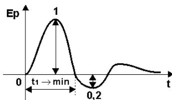
Рисунок 2.8 - График переходного процесса с 20%-ным перерегулированием
