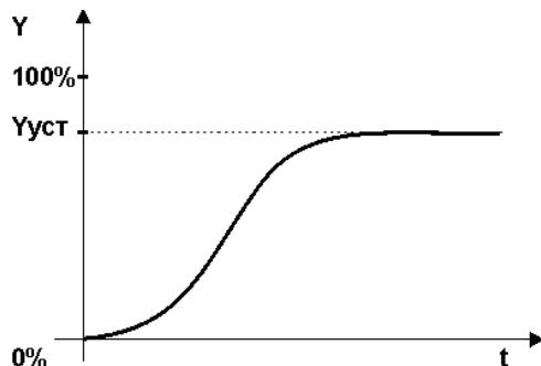
Рисунок 2.2 - Переходный процесс нагрева в печи
