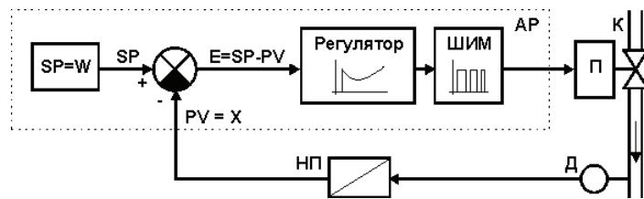
Рисунок 3.21 - Структурная схема регулятора с ШИМ выходом
