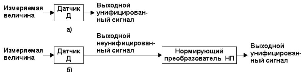
*Рисунок 1.8 - Основные структурные схемы подключения первичных преобразователей*
