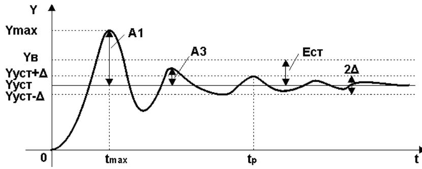
Рисунок 2.11 - Определение показателей качества по переходной характеристики
