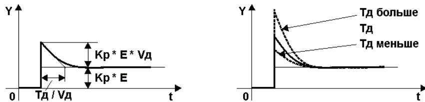
Рисунок 3.22 - ПД-регулятор. Реакция на единичное ступенчатое воздействие
