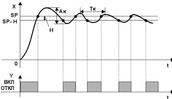
Рисунок 3.4 - Процесс регулирования с двухпозиционным законом
