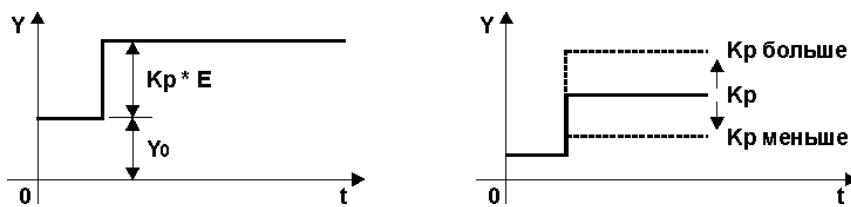
Рисунок 3.20 - П-регулятор. Реакция на единичное ступенчатое воздействие
