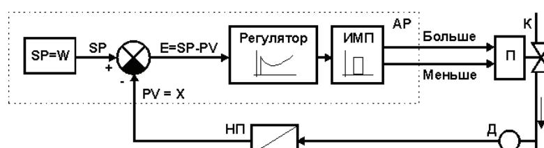
Рисунок 3.20 - Структурная схема регулятора с импульсным выходом
