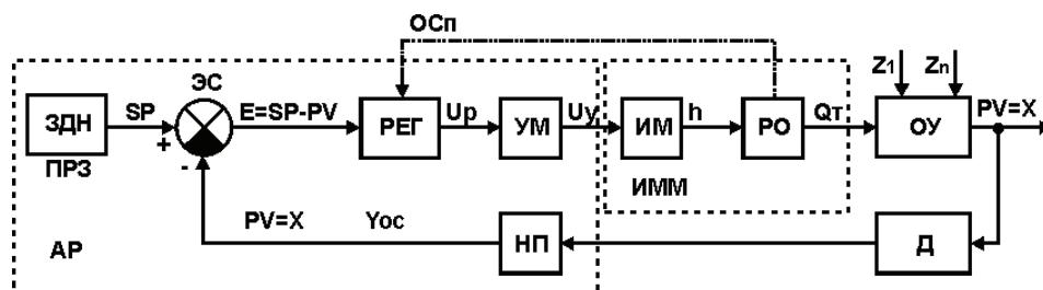
Рисунок 1.7 - Структурная схема одноконтурной САР промышленным объектом управления
