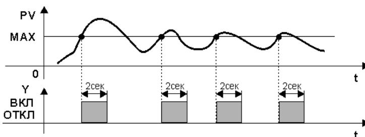
Рисунок 3.9 - Процесс двухпозиционного импульсного регулирования
