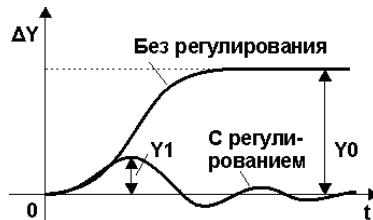
Рисунок 2.13 - К понятию динамического коэффициента регулирования
