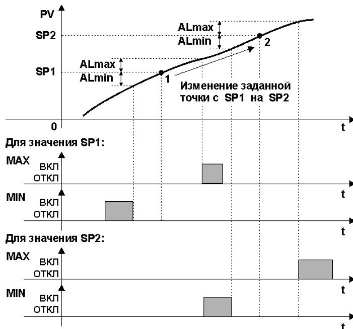
Рисунок 3.6 - Логика работы девиационной сигнализации
