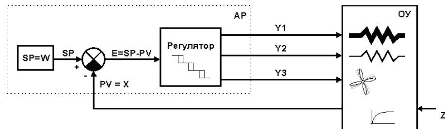
Рисунок 3.15 - Структурная схема многопозиционной системы регулирования
