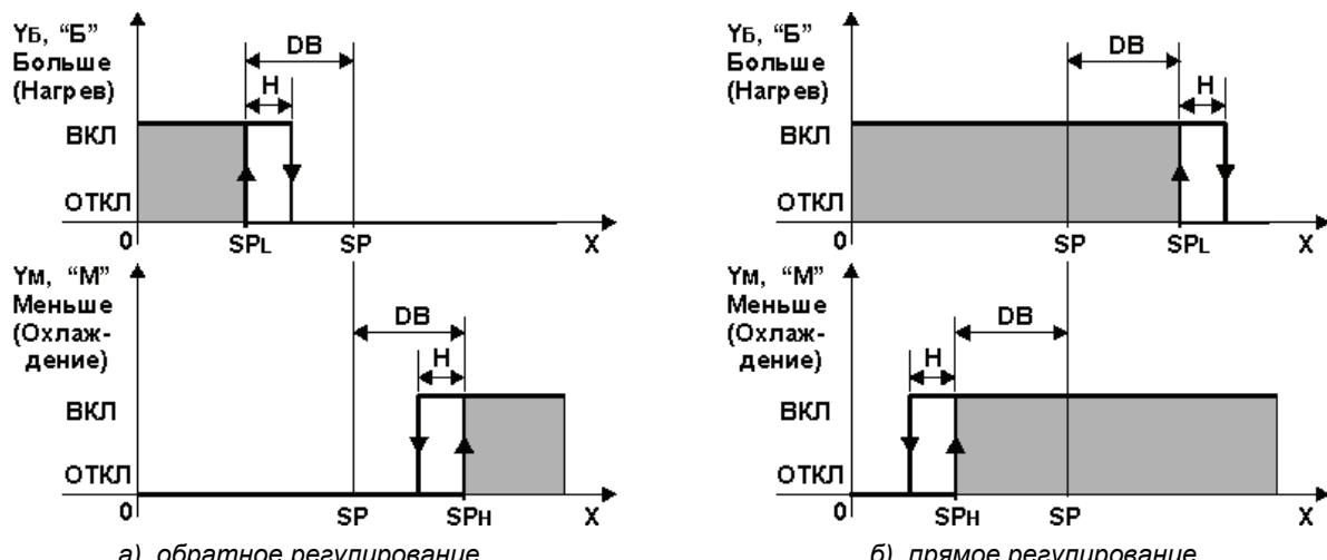
Рисунок 3.12 - Статические характеристики трехпозиционной системы регулирования
