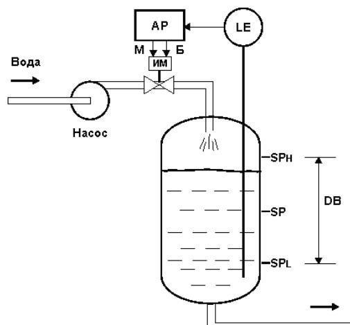
Рисунок 3.10 - Схема управления регулятором уровня в емкости
