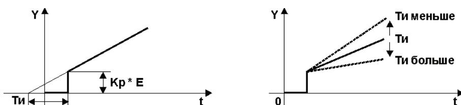
Рисунок 3.21 - ПИ-регулятор. Реакция на единичное ступенчатое воздействие
