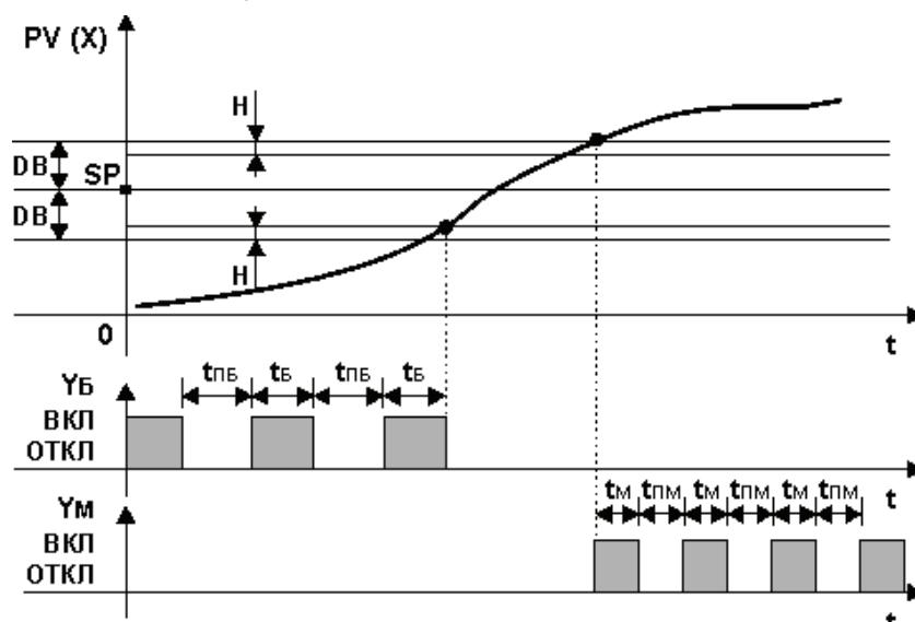
Рисунок 3.14 - Процесс регулирования с трехпозиционным импульсным законом
