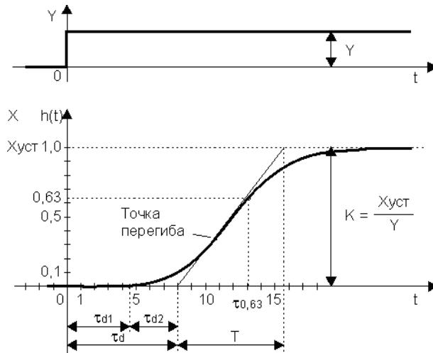
Рисунок 2.5 - Переходная характеристика (кривая разгона) объекта с самовыравниванием
