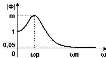
Рисунок 2.14 - График модуля частотной передаточной функции замкнутой системы
