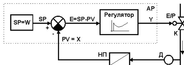
Рисунок 3.19 - Структурная схема регулятора с аналоговым выходом
