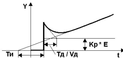
Рисунок 3.23 - ПИД-регулятор. Реакция на единичное ступенчатое воздействие
