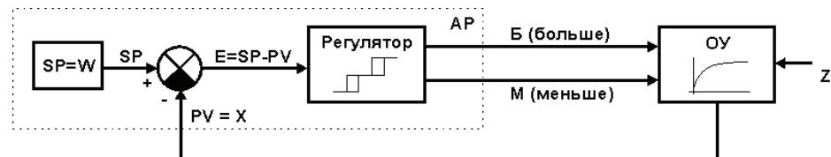
Рисунок 3.11 - Структурная схема трехпозиционной системы регулирования
