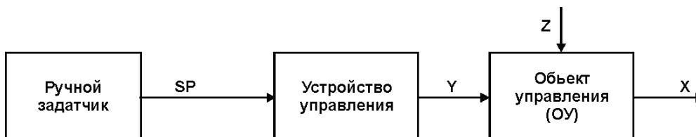
Рисунок 1.2 - Структурная схема разомкнутой системы регулирования
