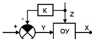
Рисунок 1.5 - Регулирование по возмущению, где: К - усилитель с коэффициентом усиления К
