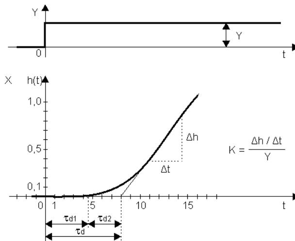
Рисунок 2.6 - Переходная характеристика (кривая разгона) объекта без самовыравнивания
