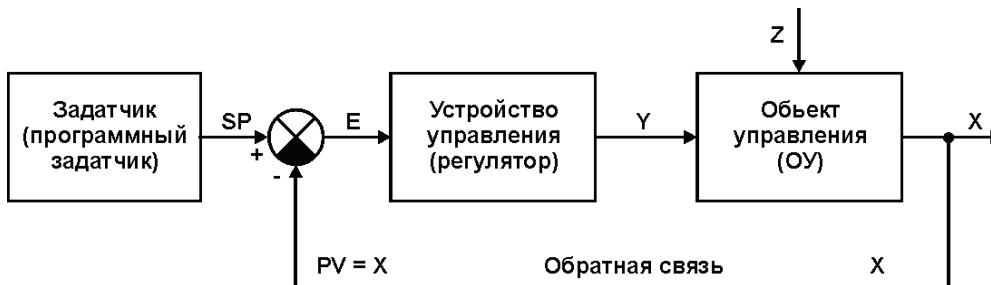
Рисунок 1.1 - Структурная схема замкнутой системы регулирования
