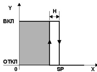
Рисунок 3.2 - Статическая характеристика двухпозиционной системы регулирования
