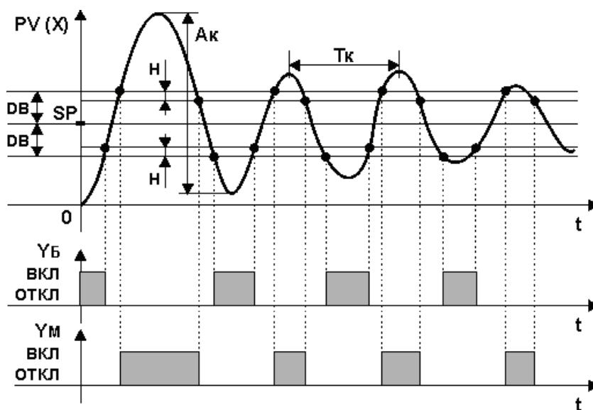
Рисунок 3.13 - Процесс регулирования с трехпозиционным законом
