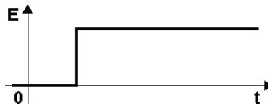
Рисунок 3.19 - Единичное ступенчатое воздействие
