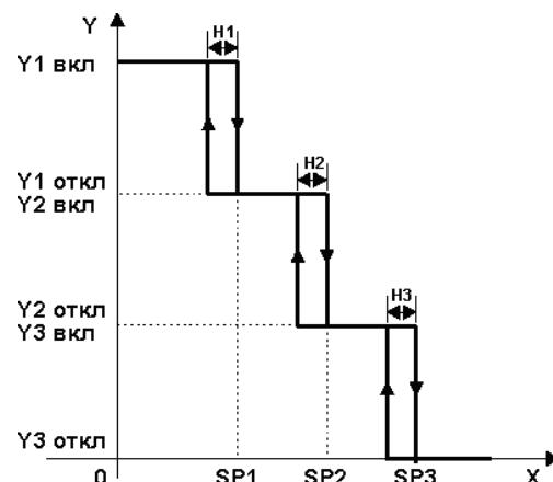
Рисунок 3.16 - Статическая характеристика многопозиционной системы регулирования
