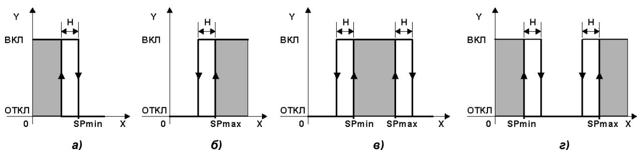
Рисунок 3.5 - Виды статических характеристик двухпозиционных регуляторов
