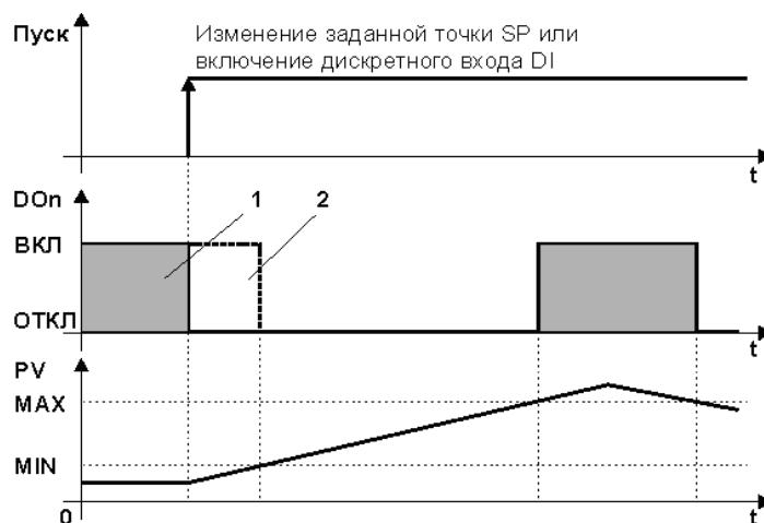
Рисунок 3.7 - Процесс двухпозиционного управления с ожиданием события
