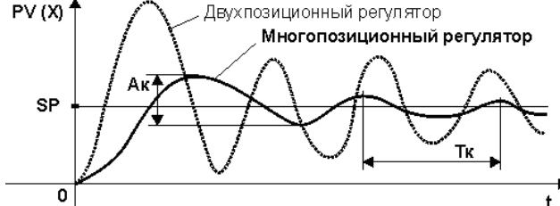
Рисунок 3.17 - Переходная характеристика многопозиционного процесса регулирования
