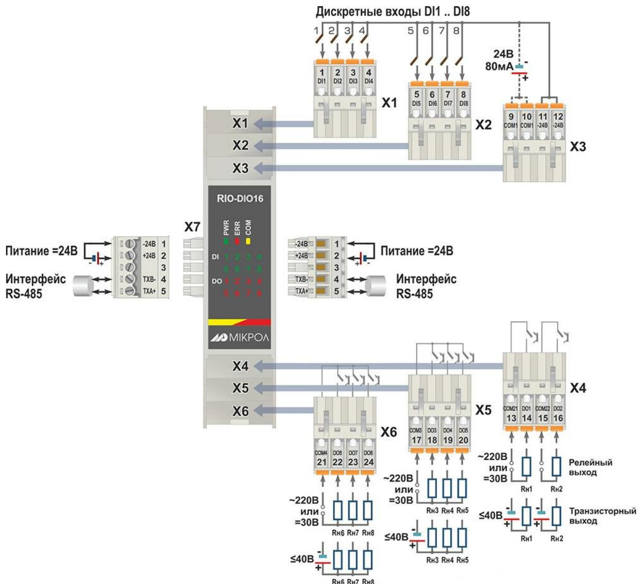
Рисунок Б.1 – Нумерация клемм и сигналы модуля дискретного ввода/вывода RIO-DIO16 для исполнения дискретных входов с однополярными входами (общий минус)
