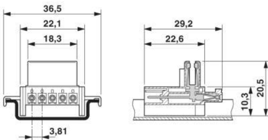
Рисунок А.2 - Габаритные размеры разъема питания РЩД-5
