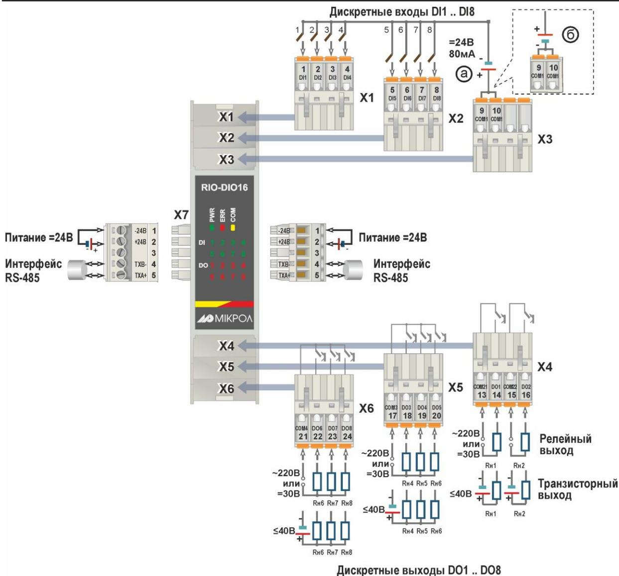
Рисунок Б.2 – Нумерация клемм и сигналы модуля дискретного ввода/вывода RIO-DIO16 для исполнения дискретных входов с двухполярными входами (общий любой полярности)
