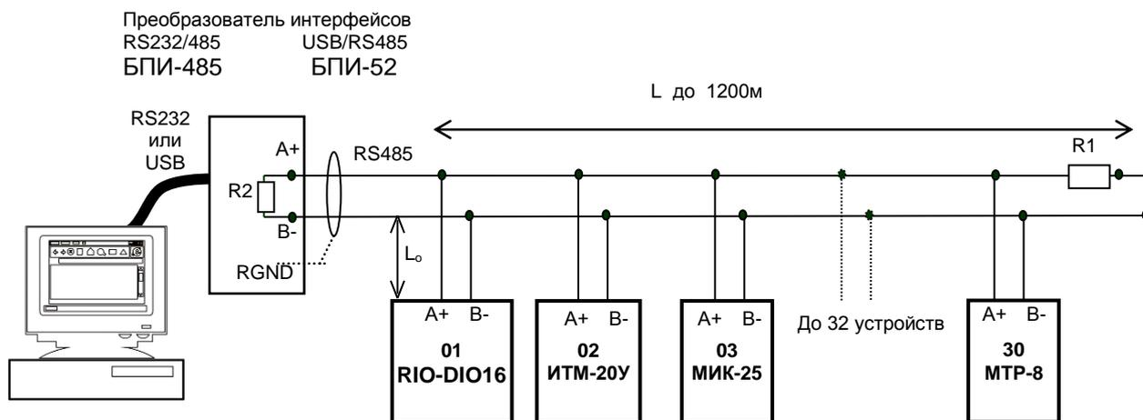
Рисунок Б.4 - Организация интерфейсной связи между ПК и устройствами
