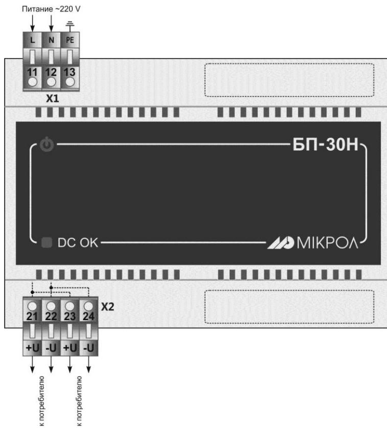
Рисунок 3.3 – Схема внешних соединений БП-30Н-1к
