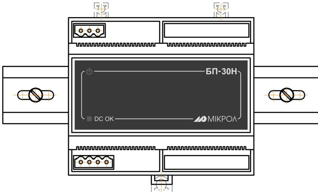
Рисунок 3.1 – Схема крепления блока на DIN-рейку
