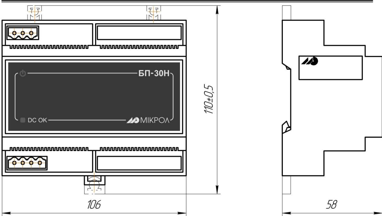
Рисунок 1.1 – Внешний вид и габаритные размеры БП-30Н-1к
