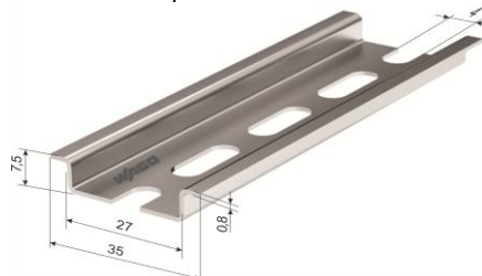
Рисунок 4.2 – Внешний вид и размеры DIN-рейки Wago
